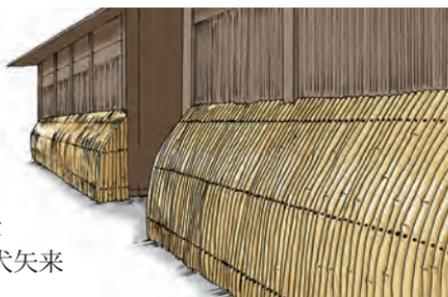
Le bas de la façade sur rue des *machiya* du Kansai est souvent protégé par un lattis de bambou en quart de cercle placé sous l'avant-toit. Comme son nom *inuyarai* (littéralement « barrière à chiens ») l'indique, ce système est destiné à mettre la partie inférieure des murs à l'abri de dégâts éventuels provoqués par les chiens, les chevaux, les passants et les véhicules.
